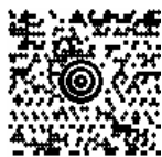
54 Data Matrix – 2335 db. alfanumerikus karaktert tárolni képes kétdimenziós vonalkód.
