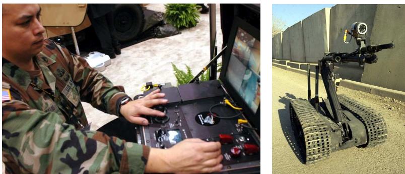
7. ábra: A TALON kisméretű távirányítású mobil robot (SMR) 92 .
