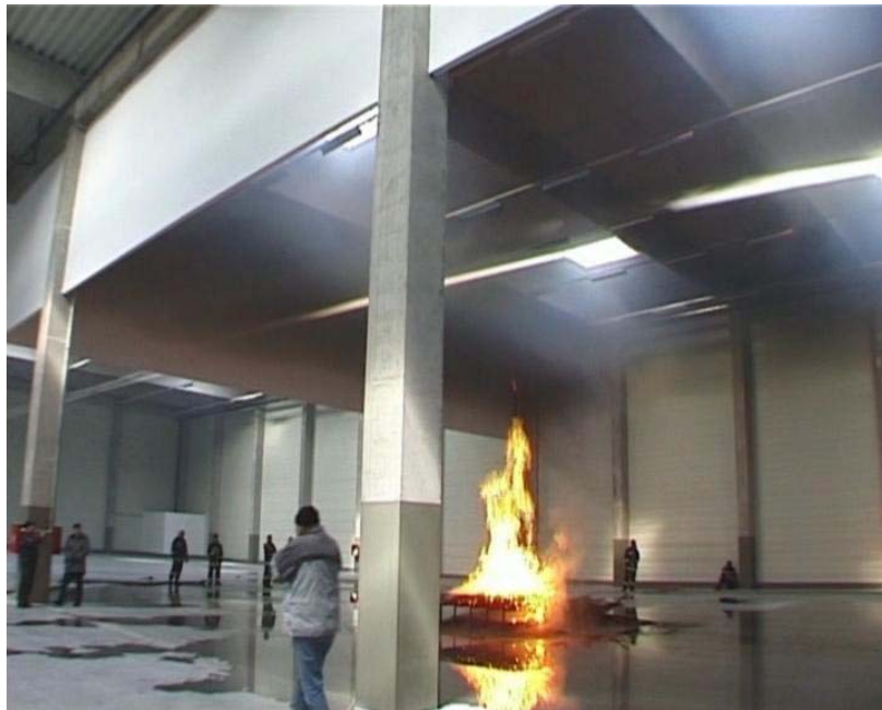
14. ábra 2005. január 17. Tűzkísérlet Dél-Budai Logisztikai Központ A korai tűzjelzéssel egy időben nyíló füstelvezető kupolák
