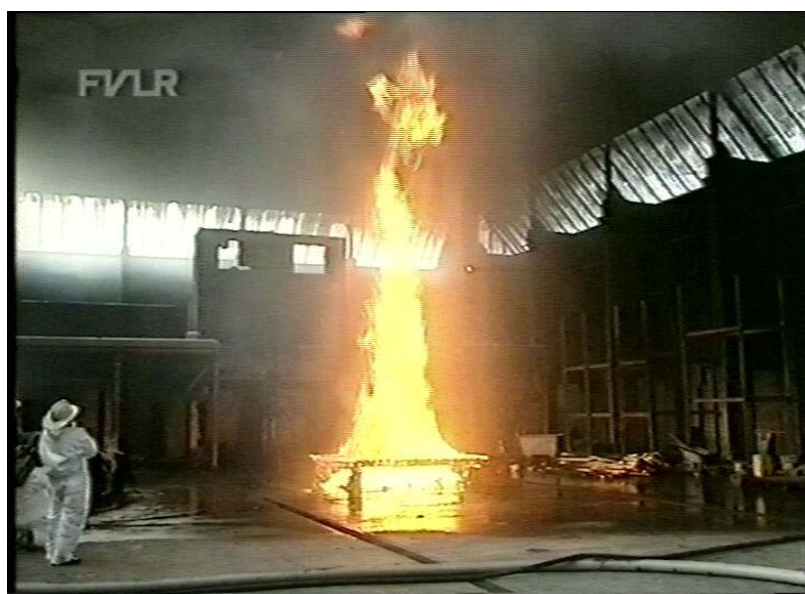
10. ábra Belgium 1998. Genti tűzkísérlet videó kép Sprinkler és a hő- és füstelvezetés együttműködése
