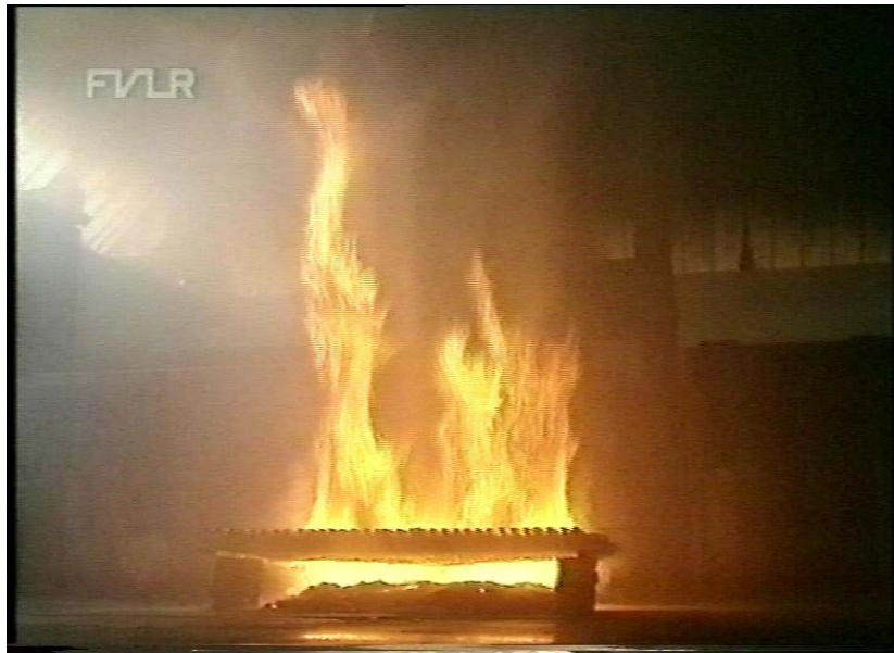
9. ábra Belgium 1998. Genti tűzkísérlés videó kép Hő- és füstelvezetés nélkül a sprinkler berendezés működése
