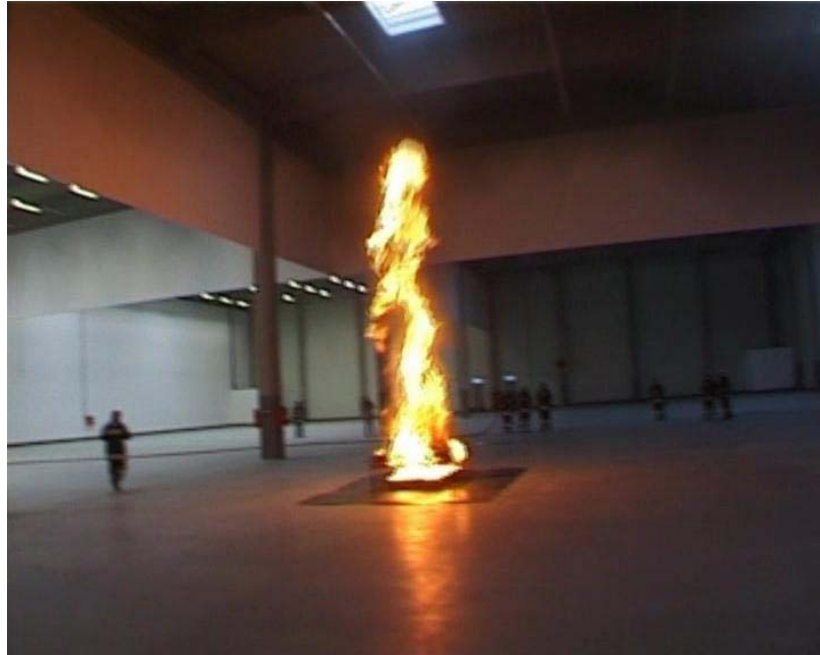
19. ábra 2005. január 17. Tűzkísérlet Dél-Budai Logisztikai Központ Lángok 1 m-re a mennyezet alatt
