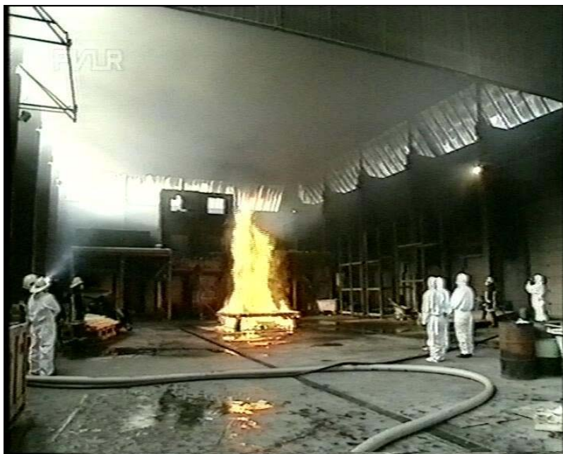
8. ábra Belgium 1998. Genti tűzkísérlet videokép Füstmentes levegő réteg kialakulása
