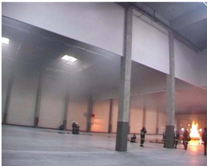
16. ábra 2005. január 17. Tűzkísérlet Dél-Budai Logisztikai Központ 12 per utáni hő- és füstelvezetés hatékonysága
