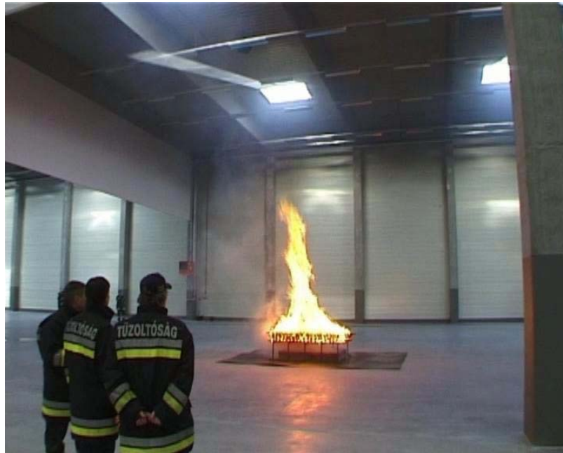
1. ábra A hatékony hő- és füstelvezetés 2005. január 17. Tűzkísérlet Dél-Budai Logisztikai Központ
