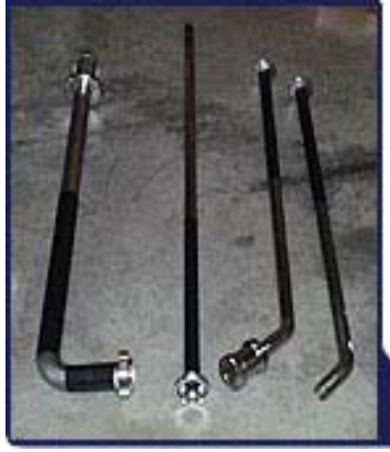
21. számú kép – szikrát nem húzó acél szívóvezetékek (Forrás: Tóth D.: Veszélyes szintet elérő vízszennyezés, mint a vízkárelhárítás speciális formája.)
