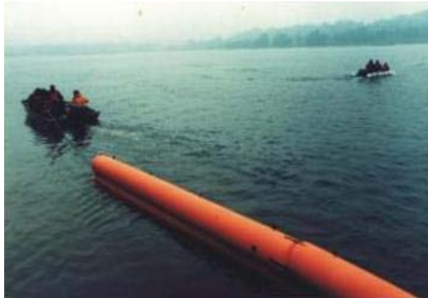
2. számú kép – kétkamrás , hosszában merülő fal, N3 típus
