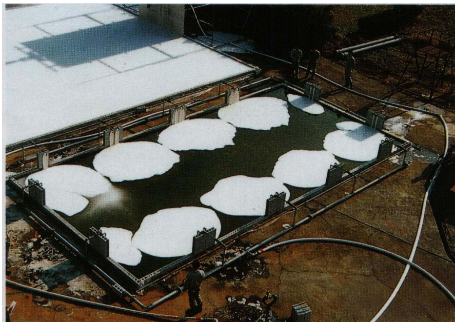
6. kép Habbevezetési kísérlet 12 ponton Fukada Kogyo kutatóközpontjában
