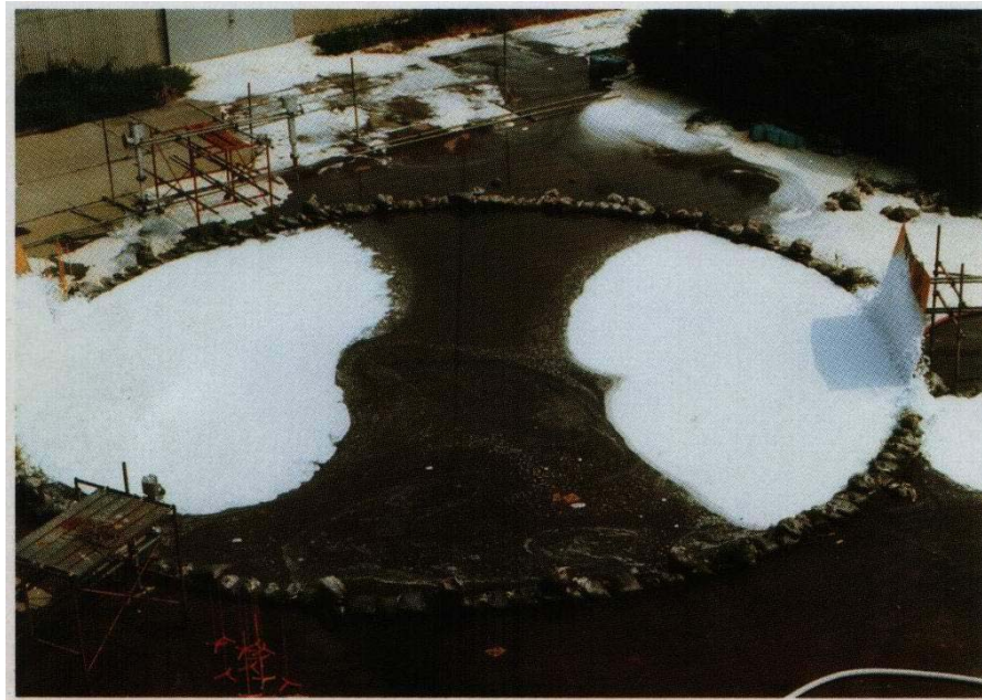
5. kép Habbevezetési kísérlet két ponton a Fukada Kogyo kutatóközpontjában (Fukada Fire Protection Systems)
