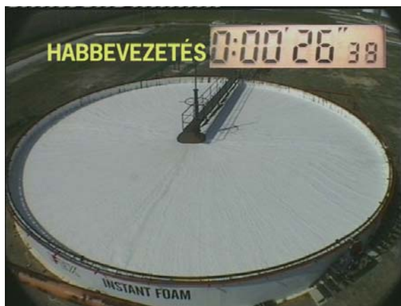
7a, b, c kép Hideg habterületi próba a folyamatos lineáris fúvóka alkalmazásával 500m 2 felületű kísérleti tartálymodellen
