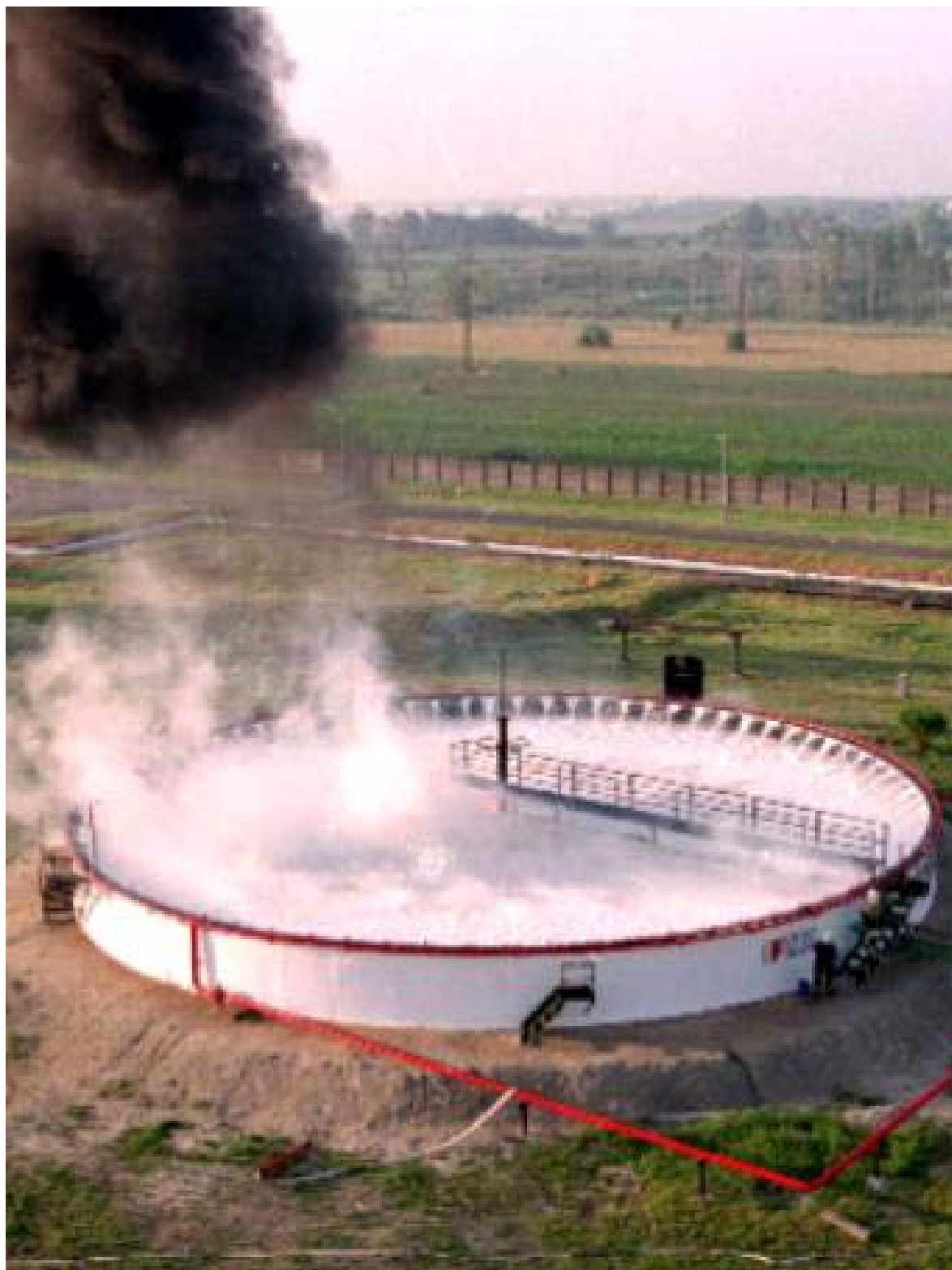
17. kép: Az oltás 25 másodperc elteltével befejeződött. A füstképződés olyan hirtelen maradt abba, "mintha elvágták volna".
