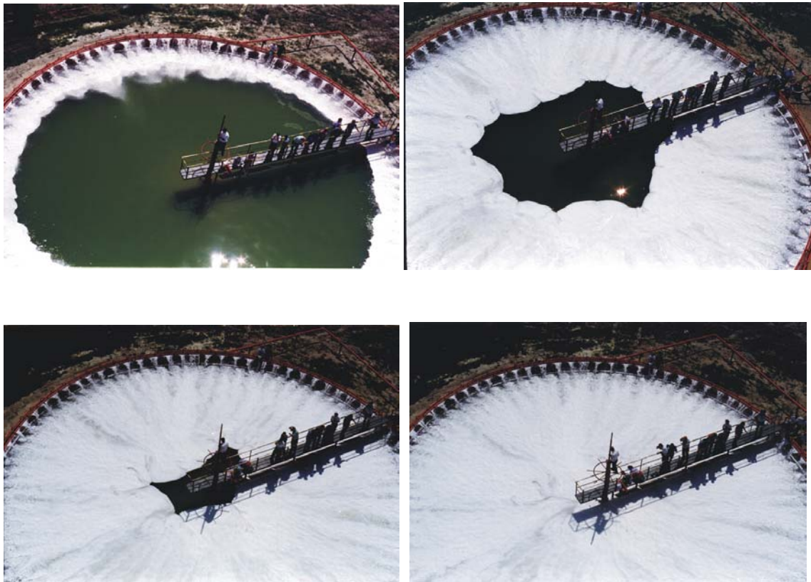
11a, b, c, d kép: A hideg habterületi próba szegmensekből álló folyamatos lineáris fúvókával, instant hab alapú habellátással
