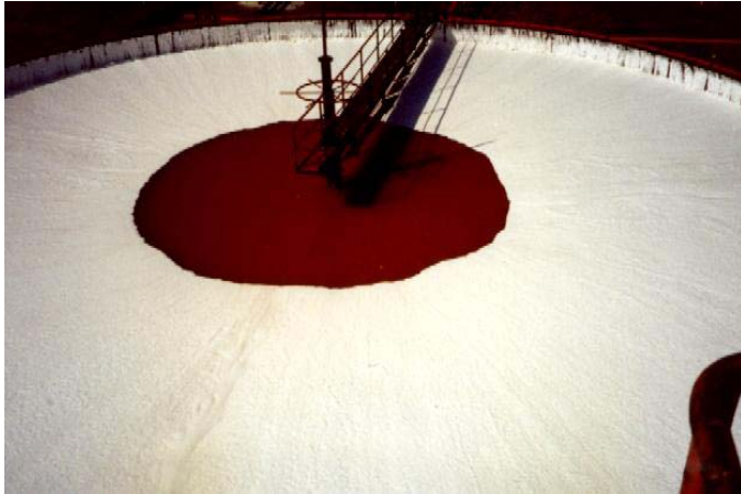
12. kép: Hideg habterületi próba folyamatos lineáris fúvókával, instant hab alapú habellátással
