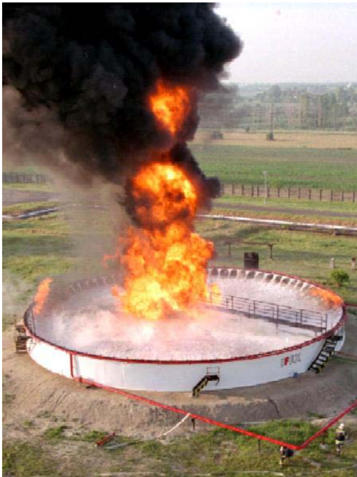
16. kép: 20 másodperccel a habbevezetés megkezdése után a hab a felület nagy részét betakarta
