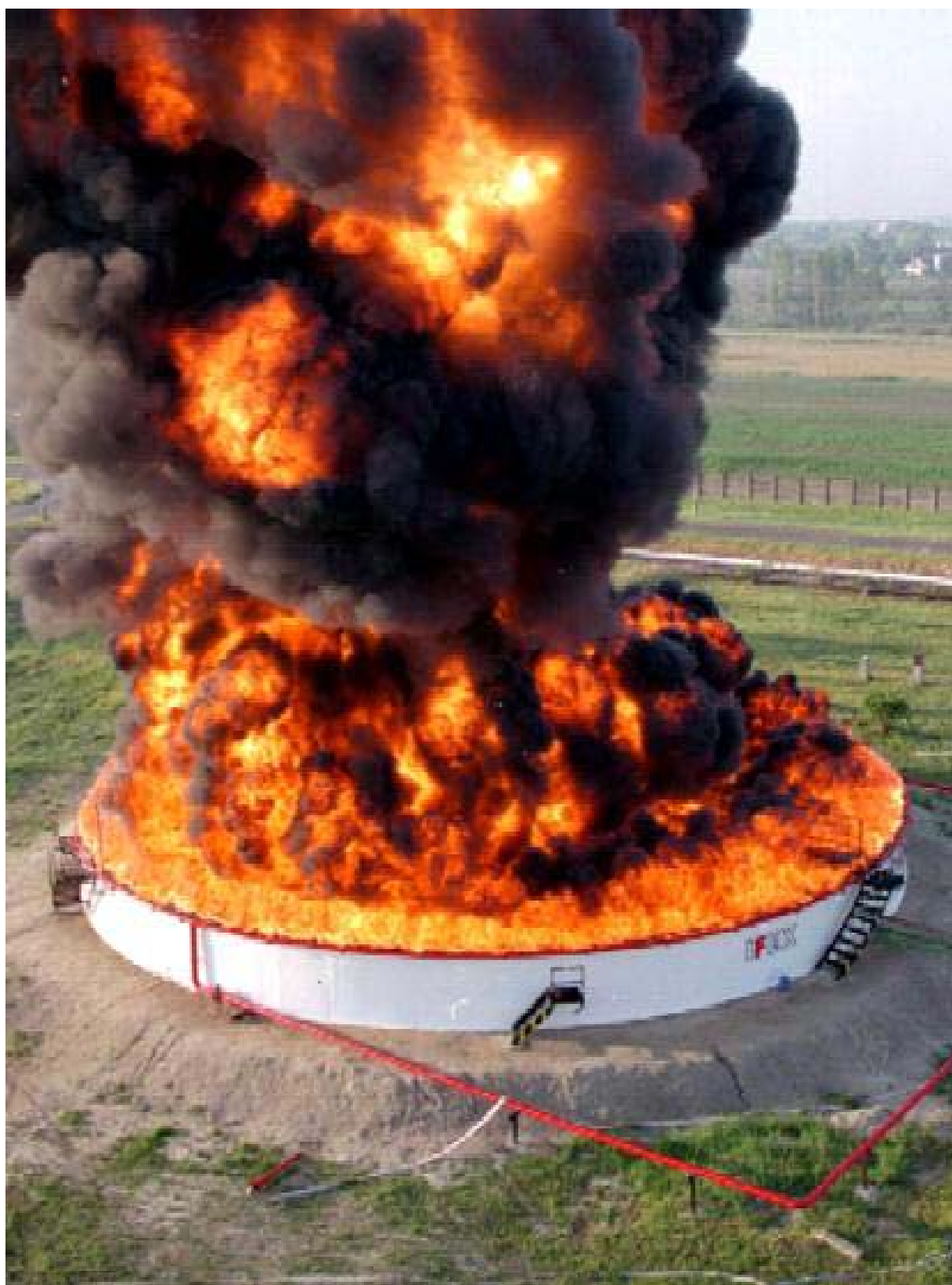
15. kép: Az 500 m 2 tűzfelületű kísérleti tartálymodell tüze 30 sec előégetési idő után. A habbevezetés kezdete
