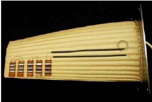
2.2. kép: Levegővel felfúj, változtatható geometriájú szárny 32
