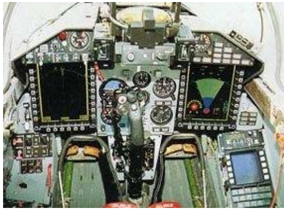
1. fénykép: A MIG-29 SMT jelű modifikációjának műszerfala /Forrás: http://www.airwar.ru/photo/mig29-2/mig-29smt-cockpit.jpg
