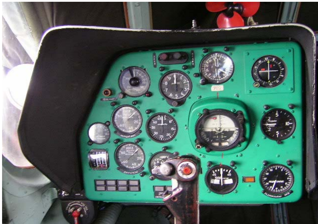
9.fénykép: A MI-17 típusú helikopter bal oldali műszerfala
