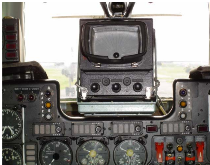
6. fénykép: A 110-es oldalszámú AN-26 repülőgép GROZA-26 fedélzeti rádiólokátor állomásának kijelző egysége /Készítette: a szerző /
