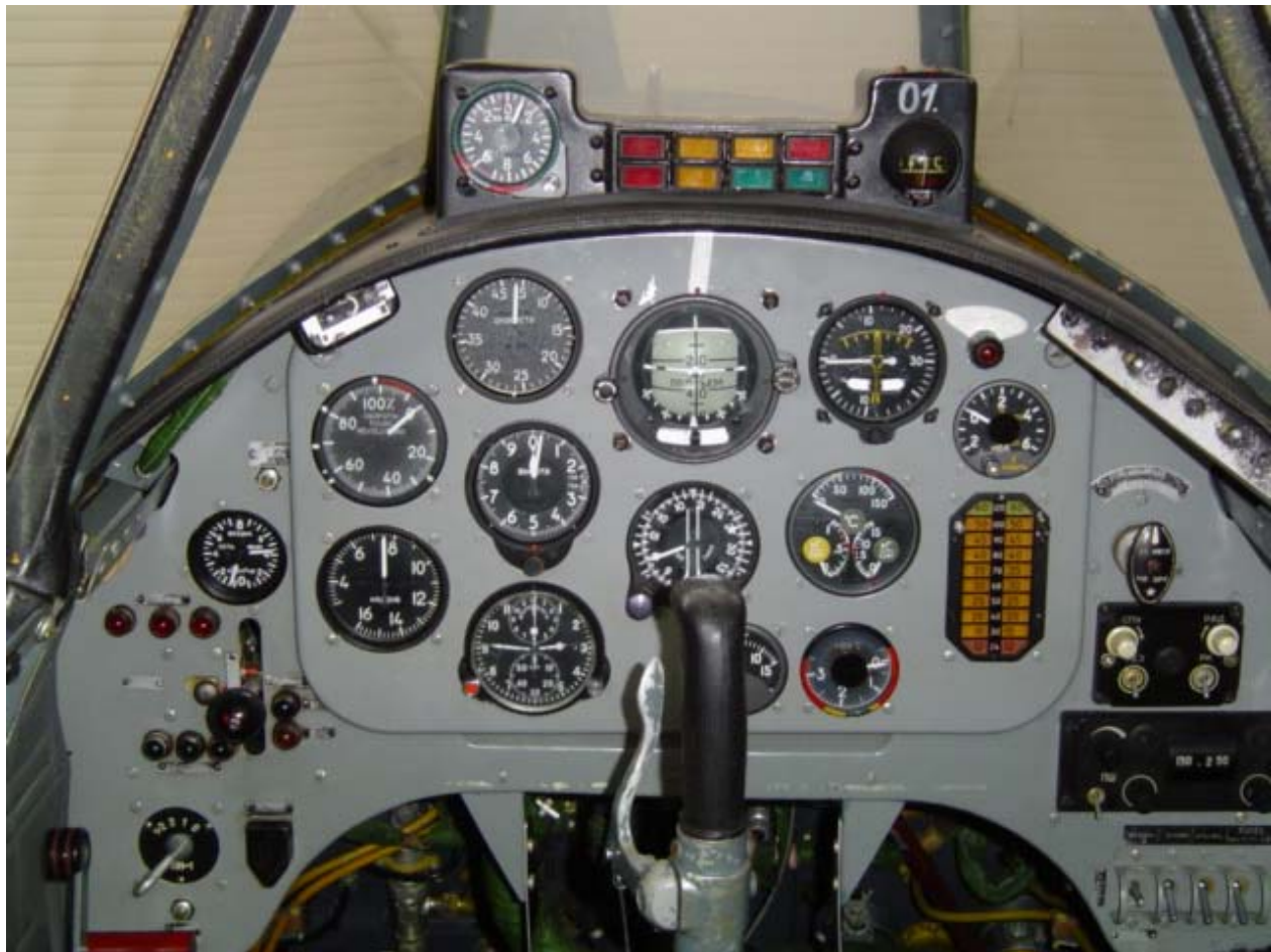
7. fénykép: A YAK-52 típusú repülőgép első ülésének műszerfala a GPS- vevők és fedélzeti válaszjel adók beépítése előtt
