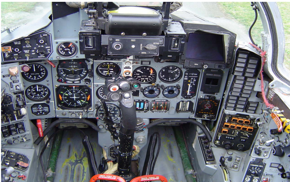
2.fénykép: Az MK tulajdonában lévő MIG-29 repülőgép kabinjának modifikációk nélküli, középső műszerfala /Készítette: a szerző/
