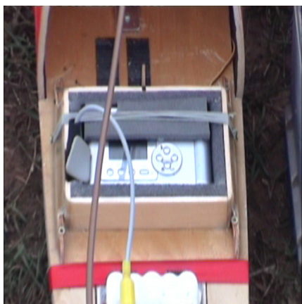
2.a kép: Digitális fényképezőgép a pilóta nélküli repülőgép fedélzetén 65
