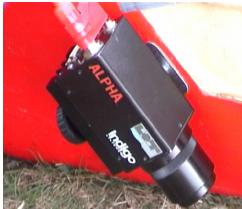
8.kép: Az Indigo Alpha infrakamera a kísérleti pilóta nélküli repülőgép fedélzetén 76
