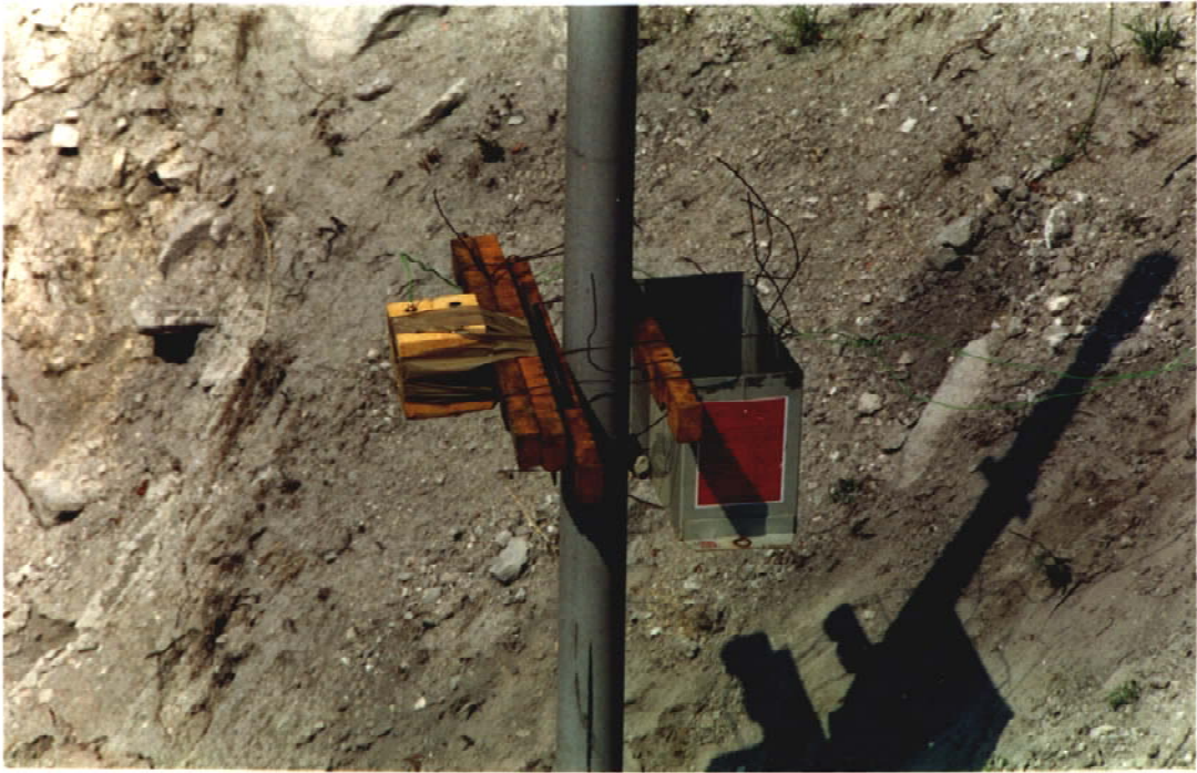
40. ábra 4 db TNT préstest elhelyezése az oszlopon
