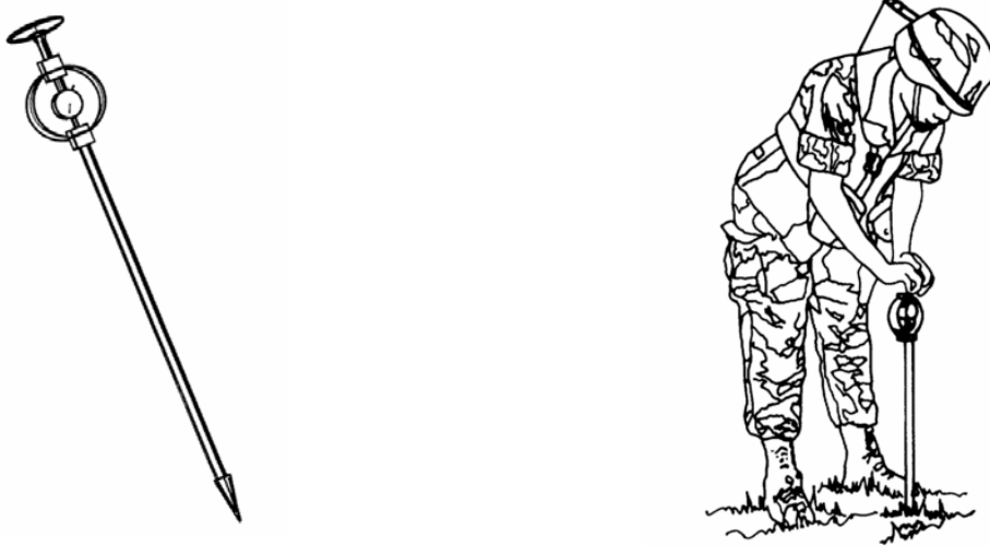
12. számú. ábra. A kúp penetrométer. FM 5-430-00-1. A talajok járhatósága. 7. fejezet.
