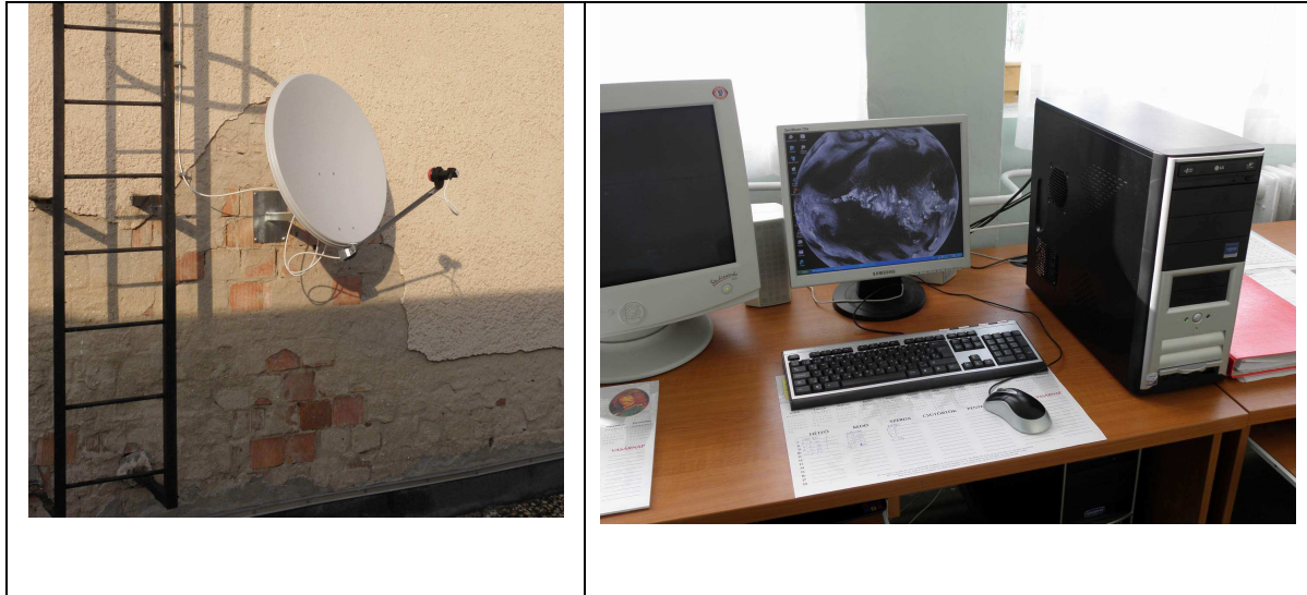
2. ábra. A ZMNE, BJKMK, RLI Repülésirányító és Repülő-hajózó tanszék EUMETCast műholdas vevőjének vevőantennája és képfeldolgozó rendszere
