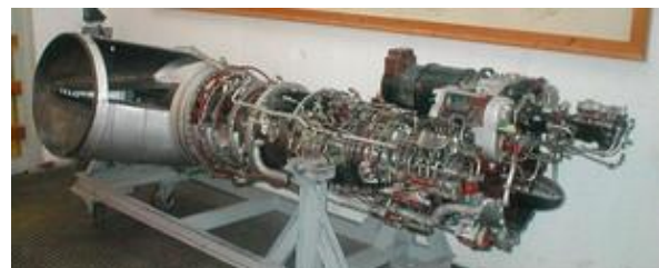
2. ábra. Az Izotov TV2-117A hajtómű volt az első orosz helikopterbe tervezett hajtómű
