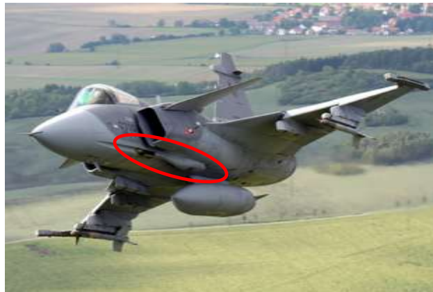
6. ábra Mauser BK-27 géppágyú elhelyezkedése a JAS-39-en
