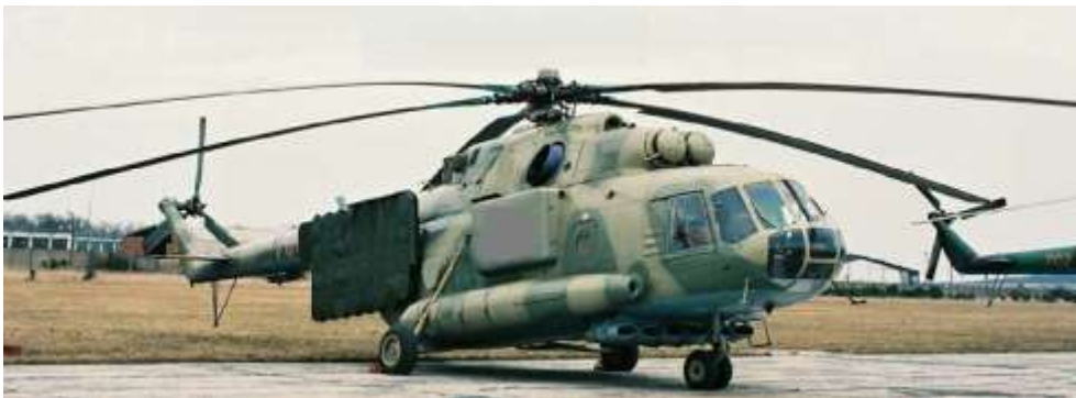
2. ábra Mi-17 szállítóhelikopter a sárkányszerkezet oldalára épített fedélzeti zavaró berendezéssel
