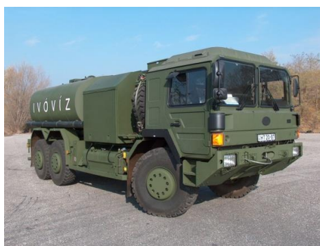
6. sz. kép 8000 literes ivóvíz-szállító terepjáró tehergépkocsi 12
