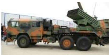
8. kép: Poland-Nexter lehetséges alváza, a képen sorozatvető csőköteggel
