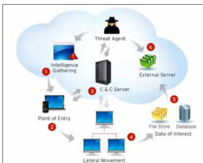
1. ábra: Egy tipikus célzott támadás és az APT (Advanced Persistent Threat) felépítése
