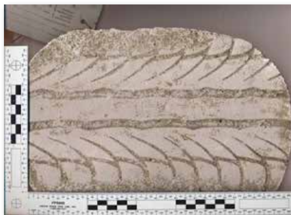
22. kép Közlekedési eszköznyom gipsszel megmintázva
