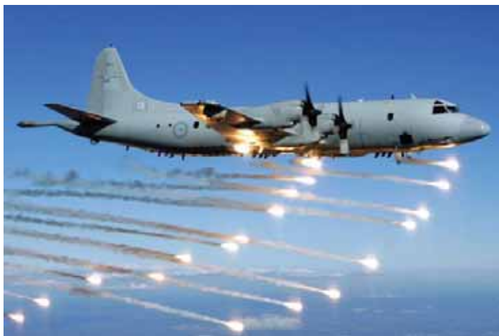
4.7. kép. Infracsapdák kidobása egy szállító repülőgépről 188
