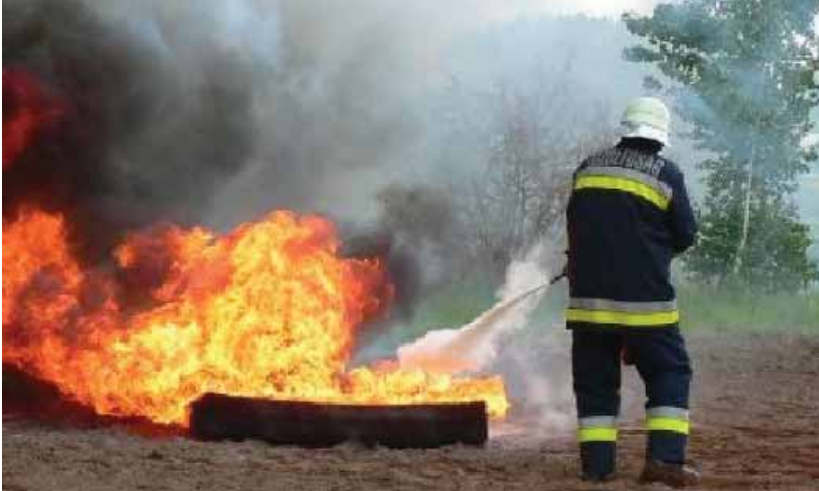
101. ábra: Oltópor alkalmazása tálcatűz oltásához
