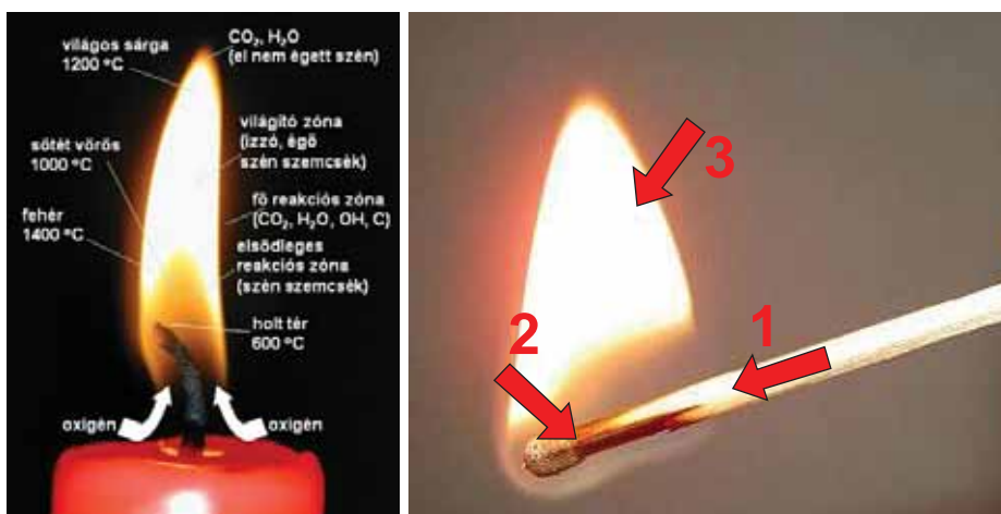
17. ábra: A láng szerkezeti felépítése, zónái
