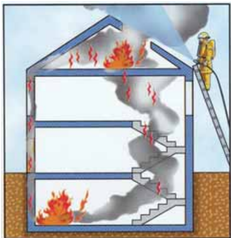
60. ábra: Tűzoltás, illetve gázcsere elősegítése tetőszintű beavatkozással
