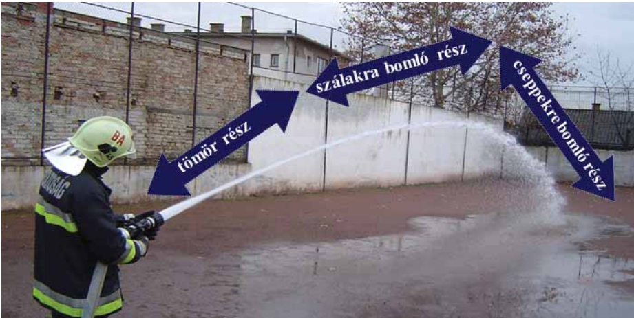
83. ábra: A kötött sugár és annak szálakra és cseppekre bomlása
