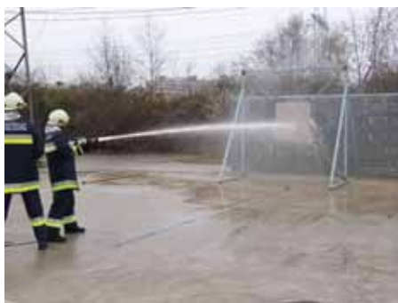
80. ábra: Feszültség alatti berendezések vízzel való oltásának biztonságát vizsgáló kísérlet
