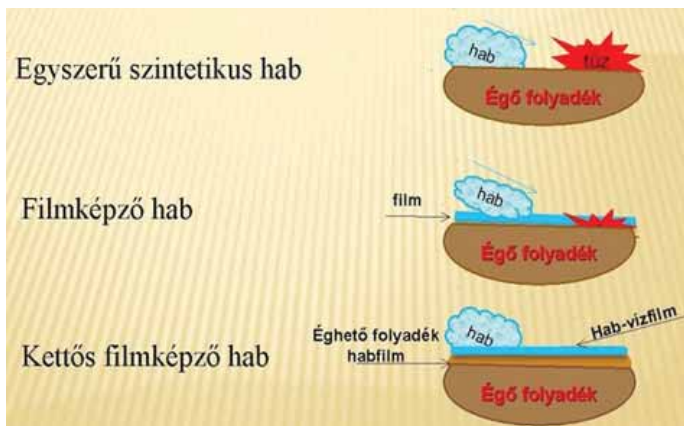
94. ábra: A szintetikus habok működési mechanizmusa
