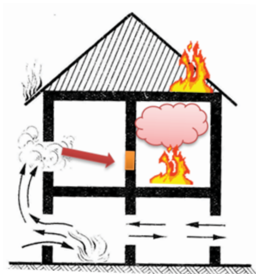
57. ábra: Homlokzati tűzterjedés
