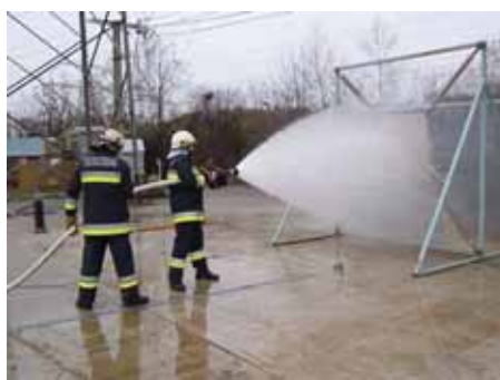
80. ábra: Feszültség alatti berendezések vízzel való oltásának biztonságát vizsgáló kísérlet
