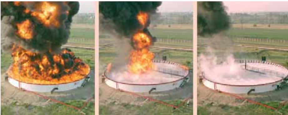
95. ábra: Szénhidrogéntároló tartály tűzoltása nehéz habbal
