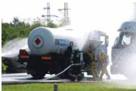
86. ábra: Gázok megkötése porlasztott vízsugárral
