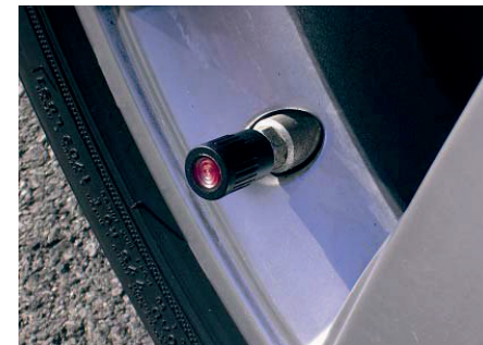
8. ábra. Szelepsapkába épített TPMS érzékelő 14
