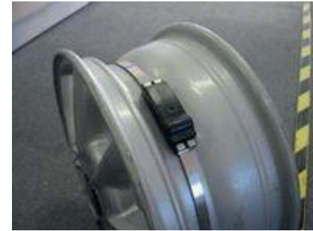
7. ábra. Kerékpántra erősített TPMS érzékelő 13
